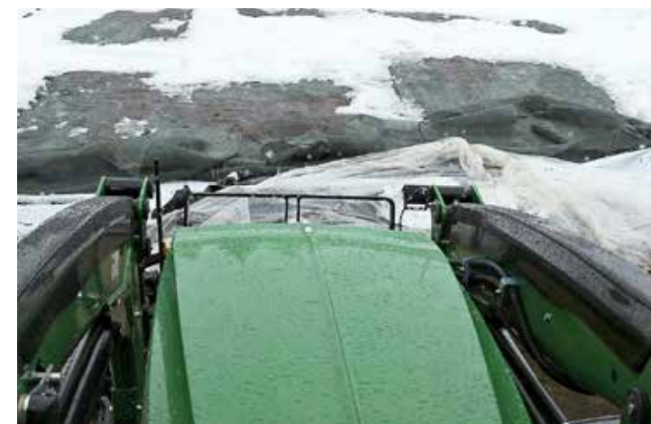
↑ Aisojen polvet ovat aiempaan verrattuna 10 senttiä alempana, mikä parantaa näkyvyyttä paitsi rehua leikatessa, myös tieajossa. Vakaimet on myös muotoiltu ylöspäin kapeneviksi.
